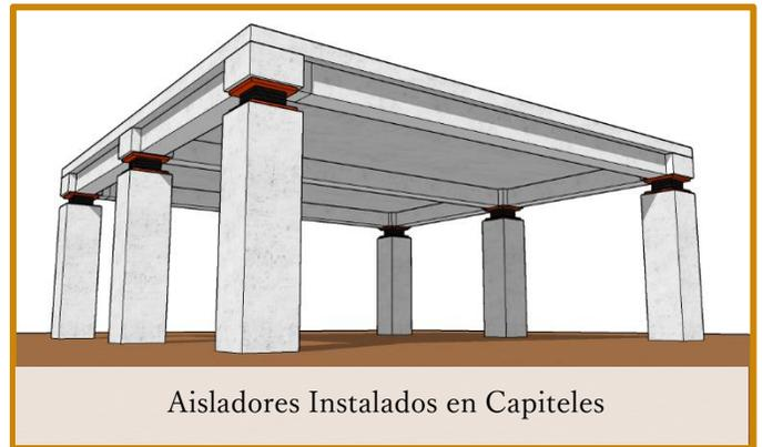
El sistema de protección sísmica por medio de aisladores sísmicos debe presentar las siguientes funciones:
