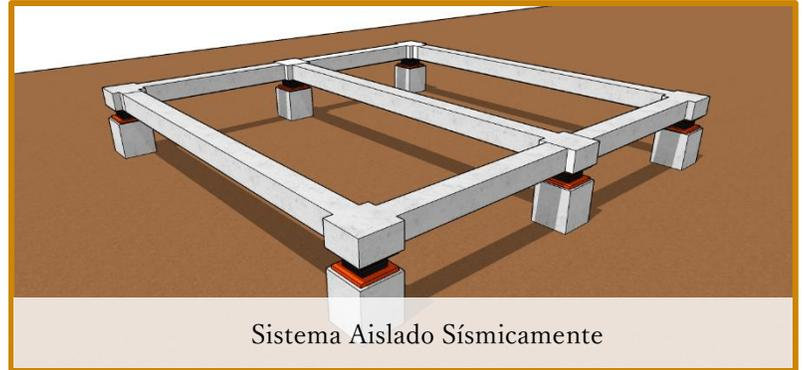
sísmico es el de desacoplar la estructura de los movimientos del terreno provocados por los terremotos que pudieran provocar daños a la estructura soportante. Esto se consigue mediante el uso de una serie de dispositivos antisísmicos llamados aisladores, que son colocados de manera estratégica sobre la cimentación de la estructura, permitiendo que actúen de manera adecuada durante un terremoto.
